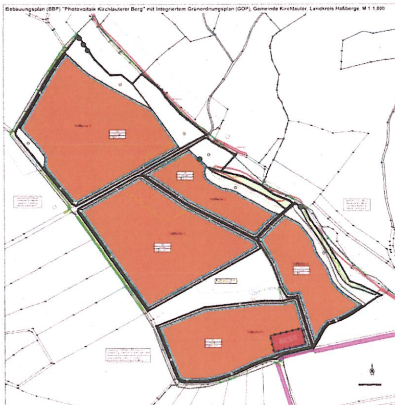
Ausschnitt aus Bebauungsplan mit markiertem erweitertem Nutzungszweck für „Graustrom-Batteriespeicher“ (BESS)
